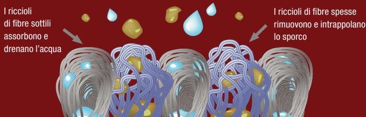
L'innovativo sistema di tessitura a doppia fibra a ricciolo di Nomad™ rimuove e trattiene efficacemente le tracce di sporco e bagnato, evitando che vengano trasportati all'interno, sporcando e danneggiando la superficie, con rischio di scivolamento per le tracce di bagnato.
